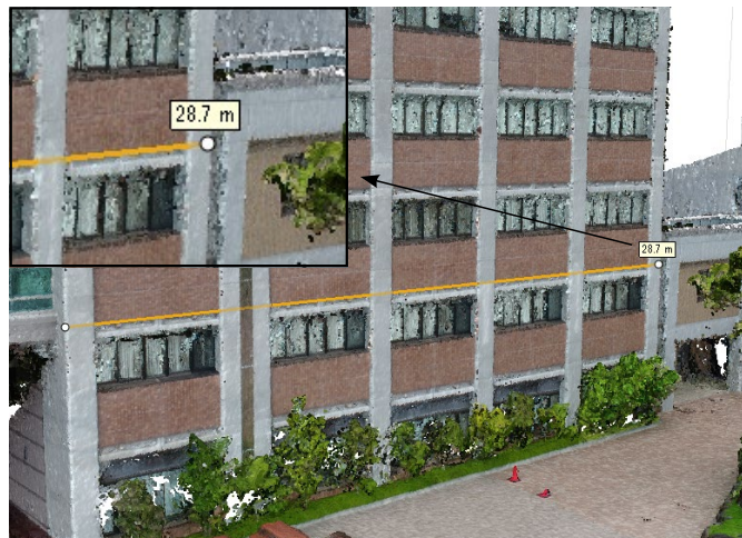
Fig. 21 3DCGモデル上の計測値
